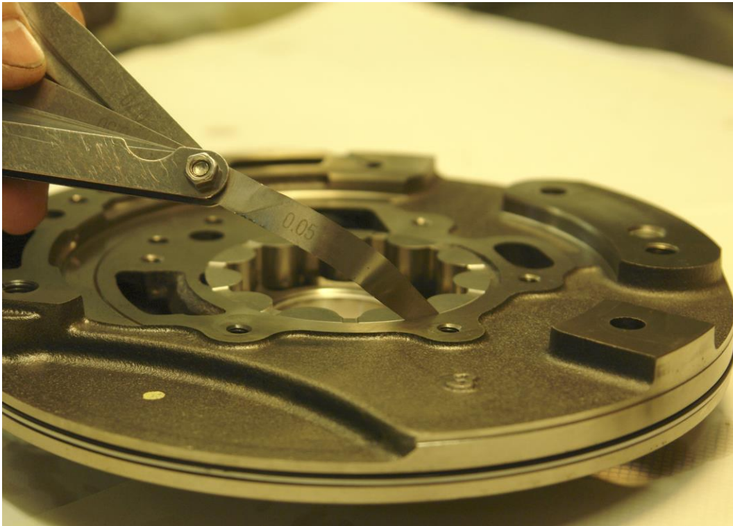
Фото 7: Измерение радиального зазора насоса: 0,05 мм (максимально допустимое значение 0,2 мм).
